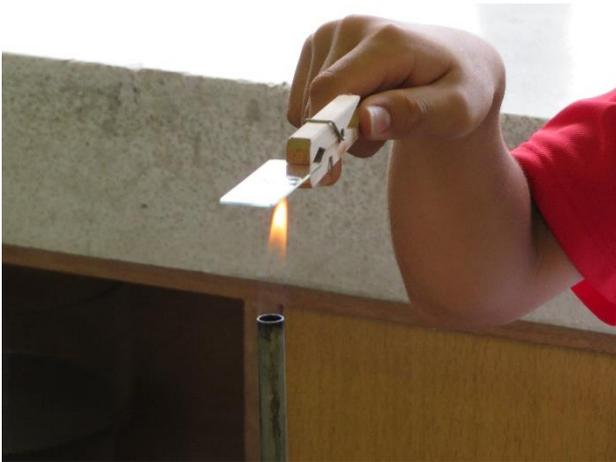
試験管に物質を溶かしたまま加熱し蒸発させようとする生徒がいる。突沸が起きやすく危険なため、スライドガラスの上に水溶液を垂らし加熱するように注意する。
