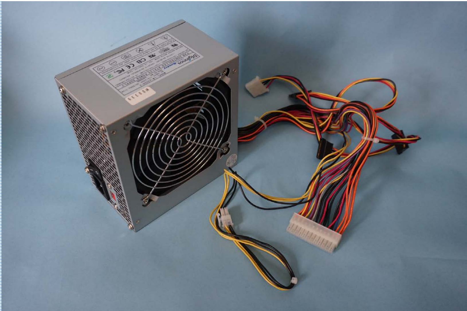
自作コンピューターから取り外したATX電源
